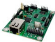
Carte de contrôle IP 6 canaux pour une gestion à distance fiable des équipements de diffusion et des systèmes RF via une interface réseau intuitive. Cette carte de contrôle IP dispose de 6 ports pour connecter et gérer 6 cartes DVB indépendantes (modulateur, récepteur, cartes d'entrée ou de sortie IP, etc.). Vous pouvez ainsi configurer n'importe quel appareil pour la diffusion TV numérique.
